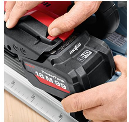
Der leistungsstarke 18 V-Lithium-Ionen-Akku ist prozessorgesteuert und überwacht alle relevanten Parameter wie Ladezustand und Temperatur.
