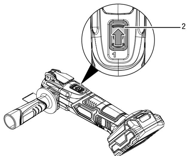
4. Zum Ausschalten des Geräts schieben Sie den Ein-/Ausschalter (2) nach hinten, sodass am Schalter **0** erscheint.
