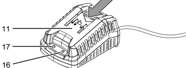
2. Stecken Sie den Netzstecker des Schnellladegerätes (11) in eine ordnungsgemäß abgesicherte Netzsteckdose.
