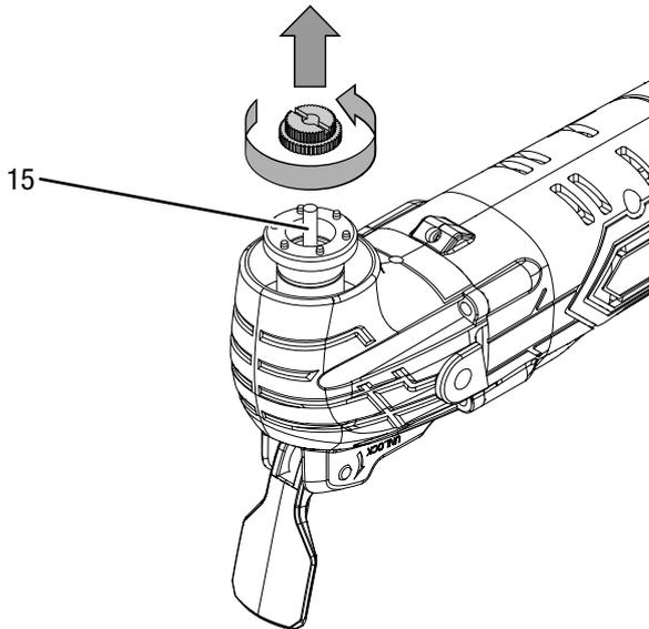
4. Setzen Sie das benötigte Werkzeug in die Werkzeugaufnahme (15) ein.
