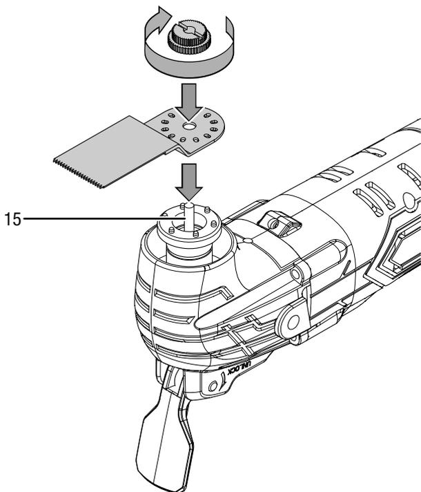
6. Schließen Sie den Hebel für die Werkzeugentriegelung (1) vollständig.
