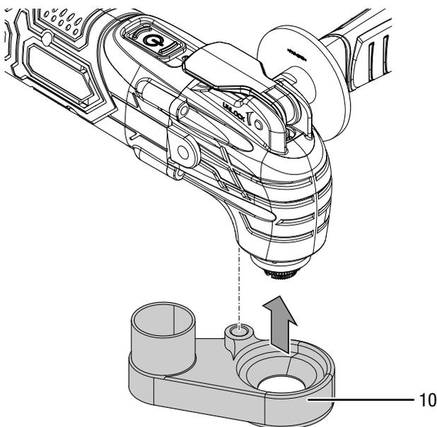
4. Schieben Sie den Winkeladapter (9) auf die Staubabsaugung (10).
