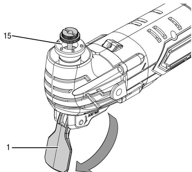
3. Lösen Sie die Spannschraube von der Werkzeugaufnahme (15), indem Sie die Spannschraube gegen den Uhrzeigersinn herausdrehen.
