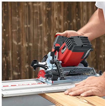
Dank großdimensionierter Winkelskala und präziser Doppelklemmung lassen sich Gehrungsschnitte passgenau umsetzen. Wie hier am Beispiel einer Fassadenschalung.
