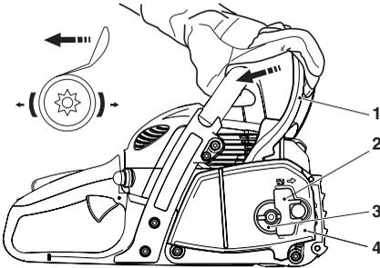
**Montage der Sägeschiene und Sägekette**
