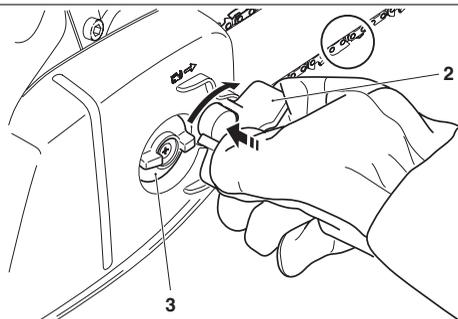
Kettenradchutz-Schnellspanner loslassen (entlasten), bis frei drehbar, dann wie in Bild dargestellt zwischen den Schutzrippen (15) einklappen.
