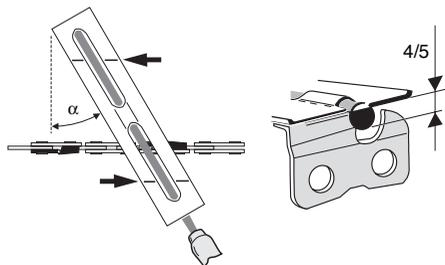
Ein Feilenhalter erleichtert die Feilenführung, er besitzt Markierungen für den korrekten Schärfwinkel von:
