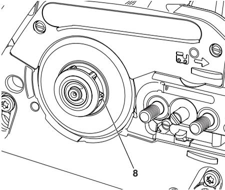
Vor dem Auflegen einer neuen Sägekette muss der Zustand des Kettenrades überprüft werden.
